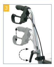
Insérer les poignées au moins jusqu'au repère « MAX » dans le tube (fig. 3). Tourner le levier de blocage dans le sens des aiguilles d'une montre pour régler la hauteur des poignées. Régler les deux poignées à la même hauteur.
