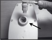
1/ Les trois brides de la bague ci-contre indiquent que le dispositif de serrage de la prise câble est déverrouillé.
