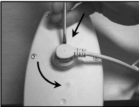
A l'aide d'un outil de type tournevis, débloquer (comme indiqué sur l'image) en appuyant dans l'encoche. En même temps, tourner la bague dans le sens des aiguilles d'une montre pour déverrouiller la prise.
