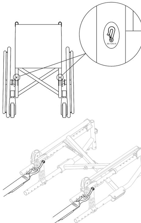
1. Fixez les mousquetons aux anneaux orange, comme indiqué sur les deux figures ci-dessus (cf. emplacement des étiquettes de fixation).
