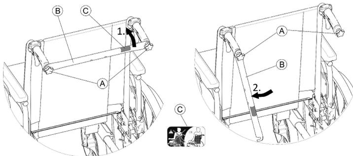
1. Desserrez légèrement les deux vis à molette (A), tirez sur le renfort de dossier (B) et faites-le pivoter vers le bas le long du dossier.
