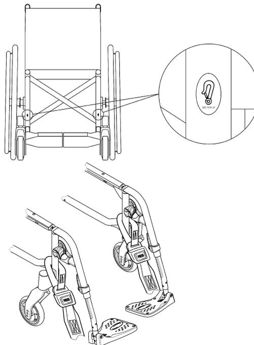
1. Fixez les sangles avant au-dessus des supports de roulettes avant, comme indiqué sur la figure ci-dessus (cf. emplacement des étiquettes de fixation).
