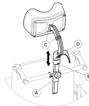
1. Desserrez la vis dans le bloc d'arrêt ⑥.
