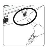
**e** Branchez l'autre extrémité du cordon des électrodes dans la prise située sur le côté de l'appareil Revitive.
