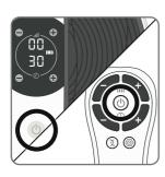
Pour allumer l'appareil, appuyez sur son bouton marche/arrêt ou sur le bouton marche/arrêt de la télécommande
